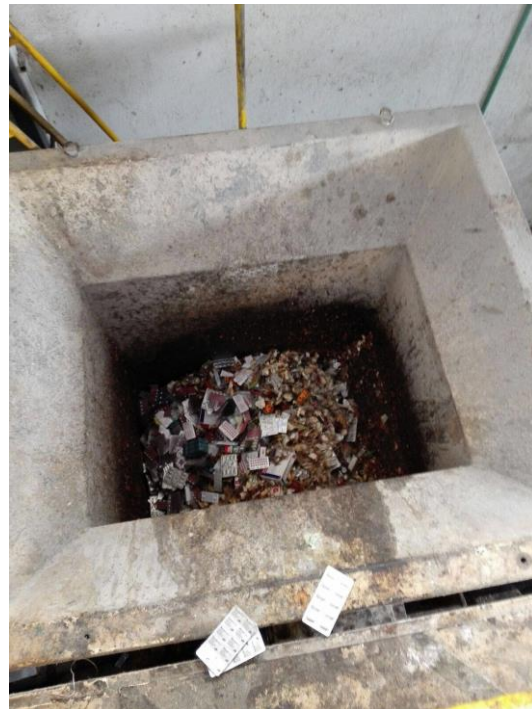
Triturador que prepara los productos para el proceso de inertización.
